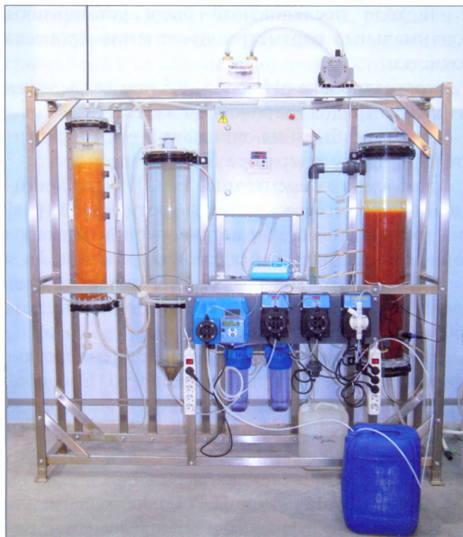
Рис. 2. Опытно-производственная установка очистки сернисто-щелочных сточных вод от сульфидов
