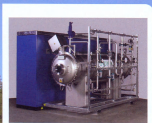
Озонаторы серии XF 14–250 кг/ч озона
