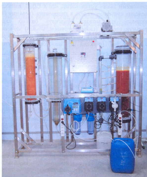
Рисунок 2. Общий вид опытно-производственной установки очистки сернисто-щелочных сточных вод (СШС) от сульфидов
