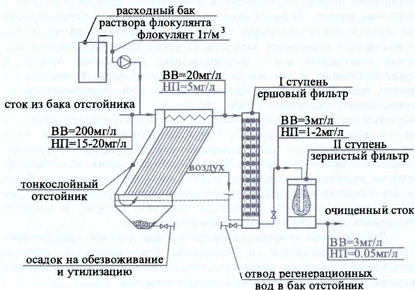
Рисунок 1. Схема опытной установки (ВВ – взвешенные вещества, НП – нефтепродукты)
