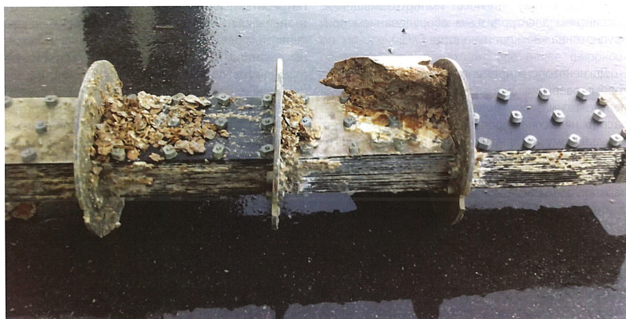
Рисунок 2 Пакет электродов спустя 5 месяцев эксплуатации на неподготовленной воде и отсутствии автоматической регулярной кислотной промывки.
