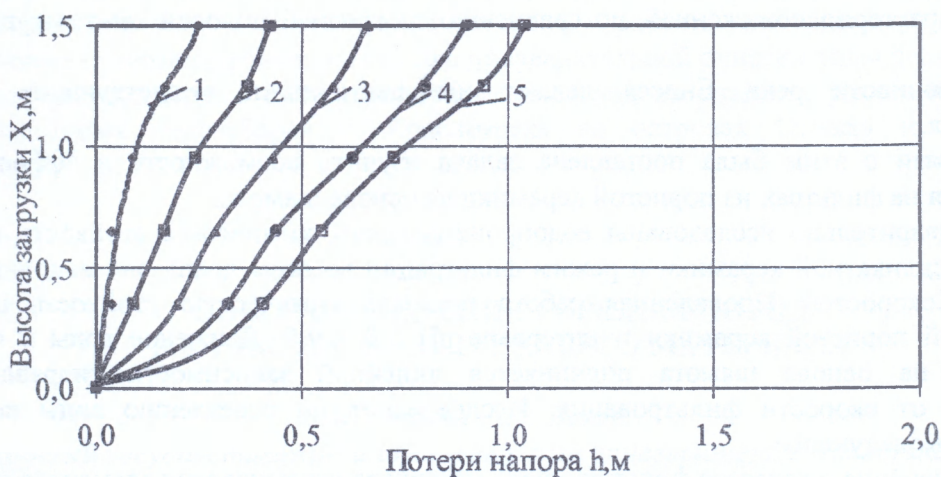
Рис. 6. Изменение потерь напора во времени по высоте фильтрующего слоя на двухслойной загрузке. Время от начала фильтроцикла: 1 – 1 час; 2 – 7 часов; 3 – 13 часов; 4 – 19 часов; 5 – 25 часов.
