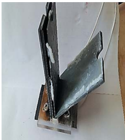
Рис. 11. Электроды и корпус электролизной ячейки после 75 часов работы в растворе с антискалентом
