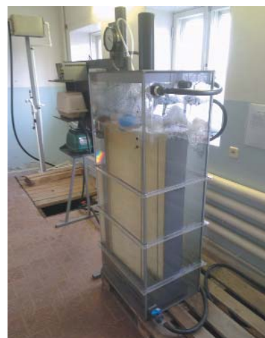
Рис. 1. Принципиальная схема пилотной установки БМР с плоскораменными мембранными элементами
