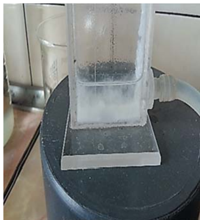
Рис. 11. Электроды и корпус электролизной ячейки после 75 часов работы в растворе с антискалентом
