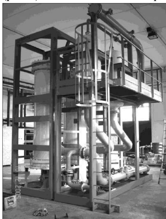
Рисунок 6. Один из четырех генераторов гипохлорита натрия электрохлораторного комплекса АЭС «Куданкулам» (в состав генератора входят три электролизера)
