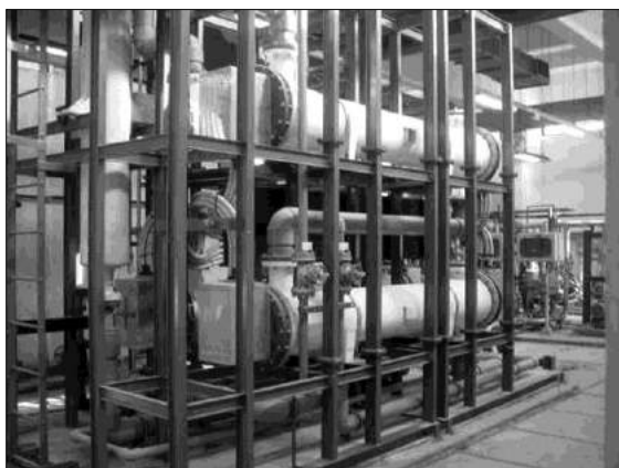
Рисунок 5. Промышленный генератор гипохлорита натрия, состоящий из четырех последовательно соединенных однотипных электролизеров
